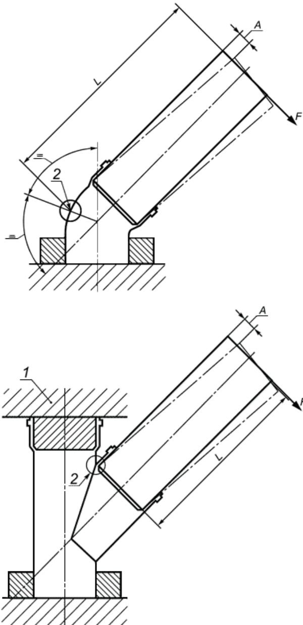
1 - фиксирующие элементы; 2 - зона возможного разрушения
