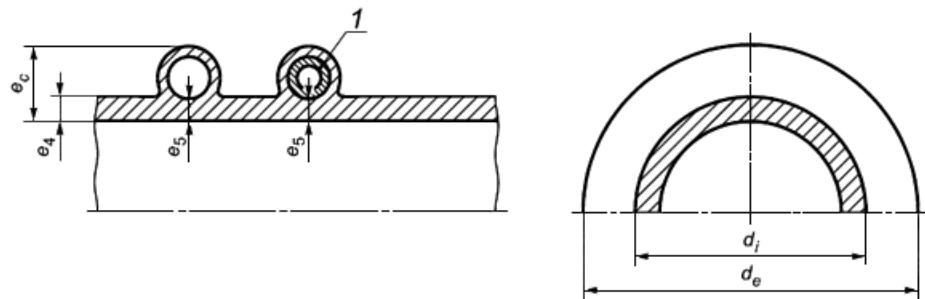
1 - конструкция может включать в себя дополнительный усиливающий профиль
