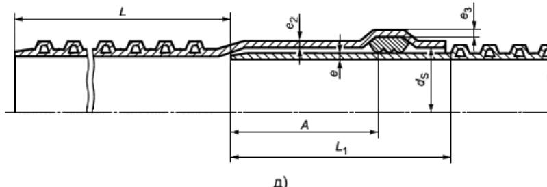
$e$  - толщина стенки трубного конца (сплошная гладкая стенка);  $e_2$  - толщина стенки цилиндрической части раstrуба;  $e_3$  - толщина стенки канавки под уплотнительное кольцо
