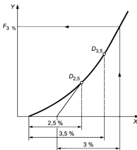
$X$  - деформация  $y$  в процентах,  $Y$  - нагрузка  $F$  в ньютонах
